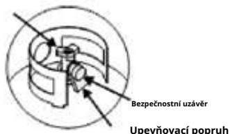
Ventil LP nádrže
