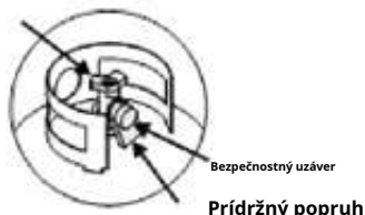
Ventil LP nádrže
