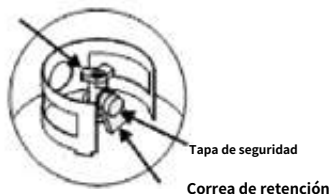
Válvula del tanque de LP
