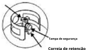
Válvula de tanque de LP
