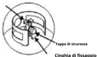
Valvola del serbatoio GPL
