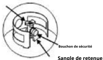
Vanne de réservoir de GPL
